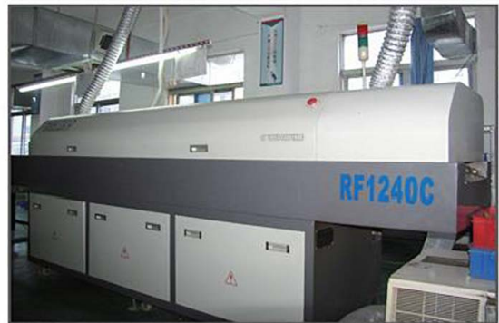
回流焊机 (Reflow soldering machine)
